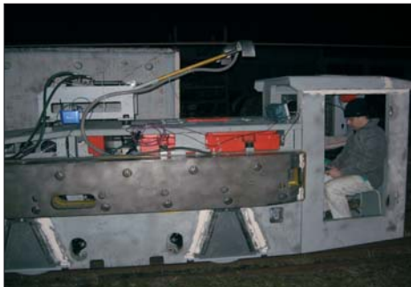
Obr. 6 Programování trolejové důlní lokomotivy pro ruský niklový důl
