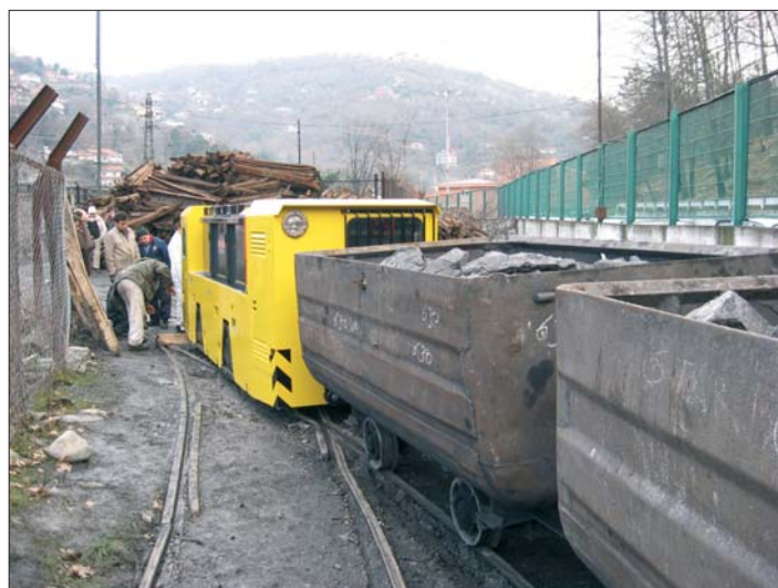
Obr. 5 Důlní lokomotiva napájená z baterie pro turecký uhelný důl (prašné prostředí)
