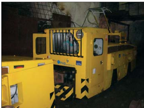
Obr. 4 Důlní lokomotiva napájená z troleje v ruském železaružném dolu
