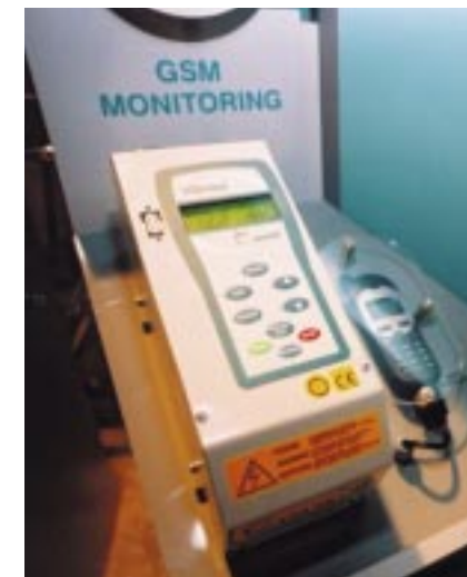
Frekvencný menič typového radu VQFREM možno ovládať aj pomocou mobilnej siete
