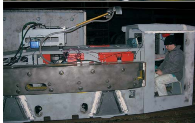
Obr.1 Nastavovanie softvéru pohonu banskej lokomotívy pre ruskú niklovú baňu
