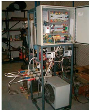
Obr.4 Špeciálny frekvenčný menič ako akčný člen v tepelnom čerpadle
