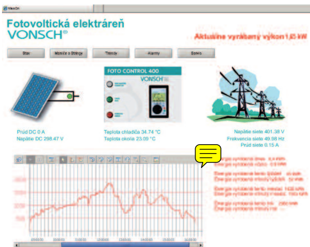
Príklad monitoringu fotovoltaickej elektrárne VONSCH
